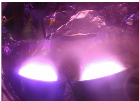
圖 8. 儀科中心所開發封閉式電漿濺鍍系統。
