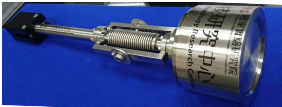
圖 7.3 吋非平衡圓形磁控濺鍍槍。
