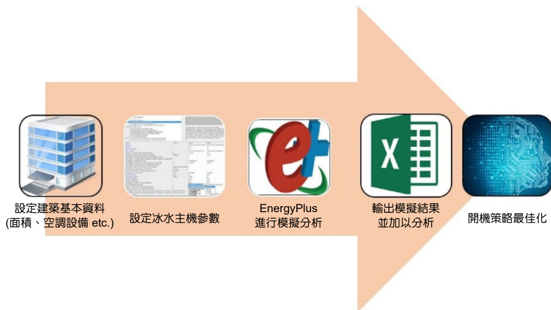
圖 6. 透過 EnergyPlus 模擬來分析空調狀況。
