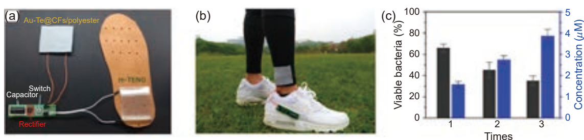
圖 12. 殺菌系統裝置 (a) 內部元件 (b) 裝置應用示範 (c) 不同充電放電次數之下細菌存活率與 \text{H}_2\text{O}_2 產生濃度。
