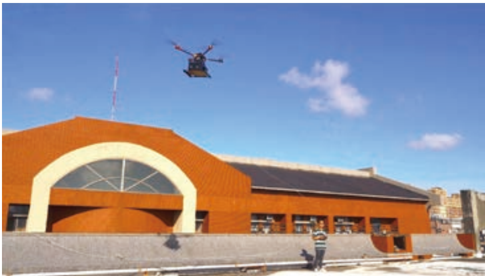
圖 12. 本團隊開發之光學式二氧化氮氣體感測系統結合無人機進行移動偵測。
