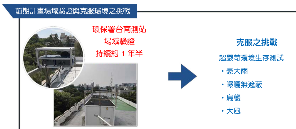
圖 8. 本團隊開發之光學式二氧化氮氣體感測系統於環保署台南測站設置狀況。
