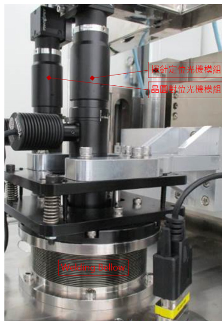
圖 2. 整合自動光學對位系統與探針點測裝置調校機構之實體圖。
