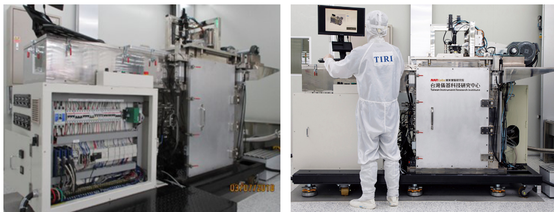
圖 4. 晶圓級氣體感測器高效能電性量測系統設備實體圖。
