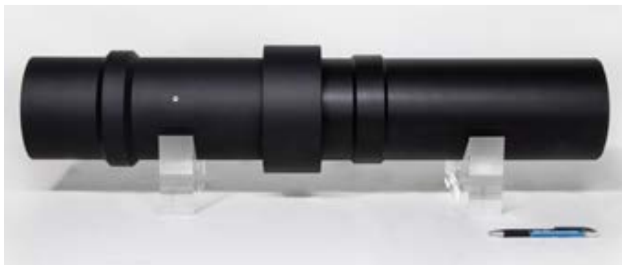
圖 20. 物鏡與筒鏡組裝結合之工程體。
