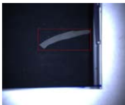
圖 2. 掉落物瑕疵影像。
