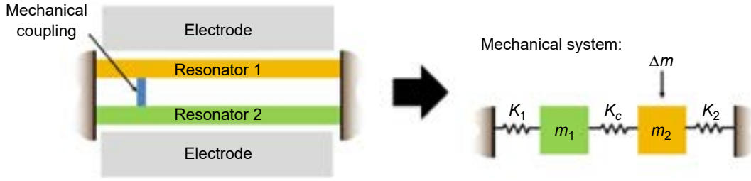
圖 2. 對稱式雙維度耦合諧振器之物理模型示意圖。
