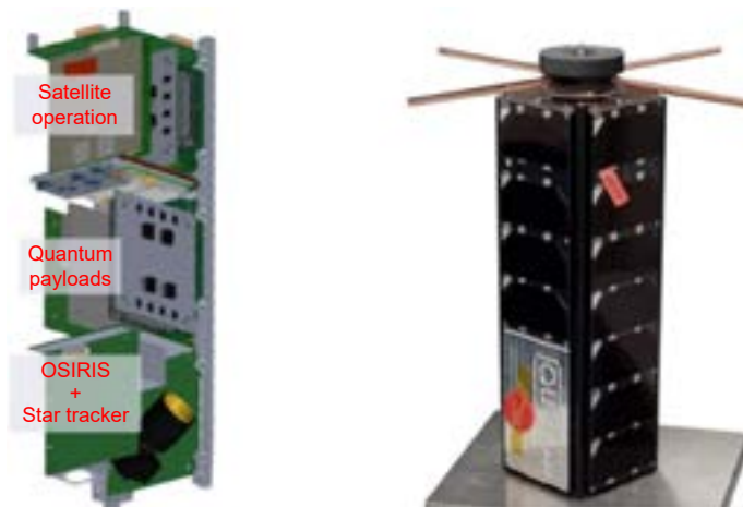
圖 8. 左：衛星主要模組圖、右：3U 衛星 QUBE 照片 (14) 。
