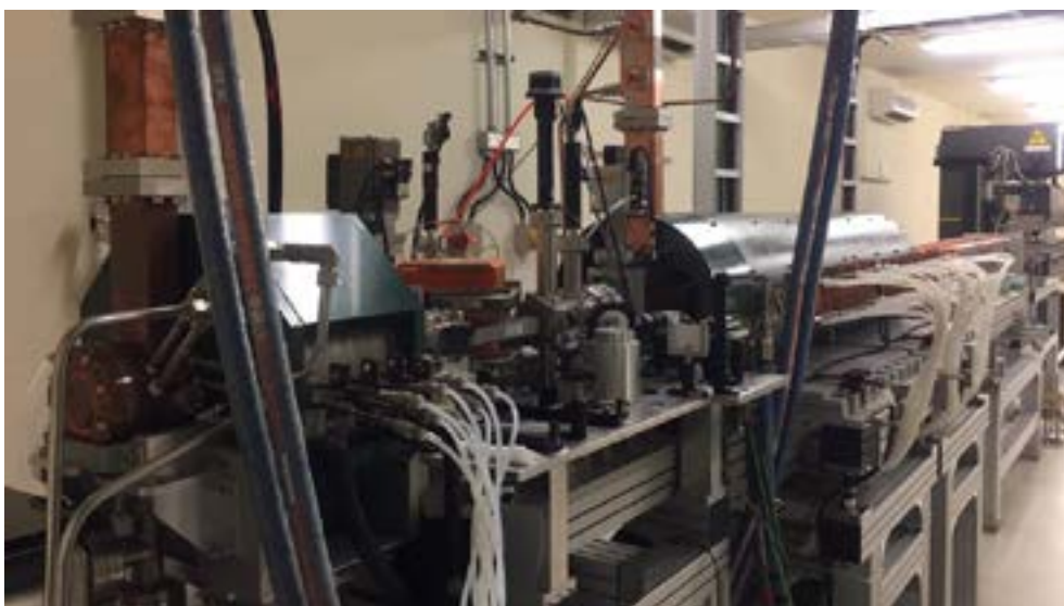
圖 4. 由國家同步輻射研究中心所研發的 2998 MHz 光陰極微波電子槍系統。
