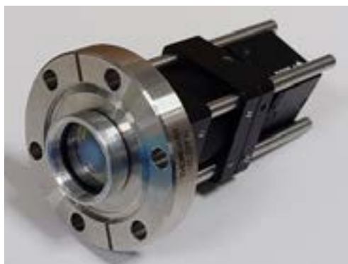
圖 6. FND-EUV 成像裝置圖 (13) 。
