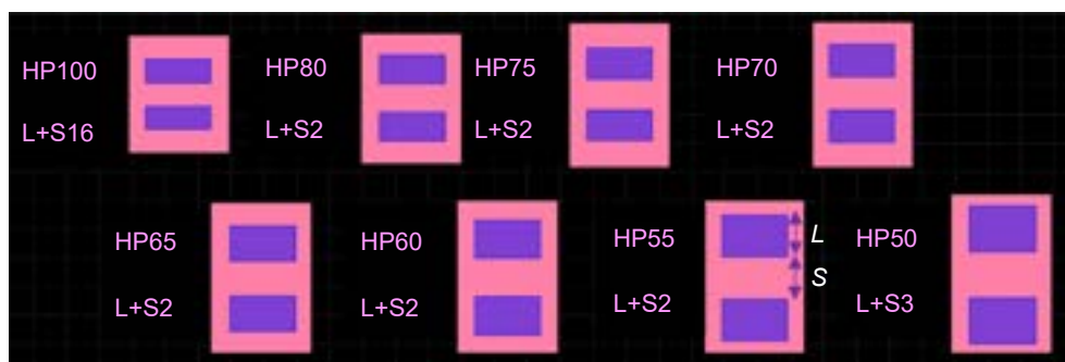
圖 2. EUV-IL 光罩圖樣設計示意圖，半間距 (half pitch) 從100 nm 至 50 nm，光柵視窗+阻擋層間隔 (L+S) 需小於光源的空間同調長度。
