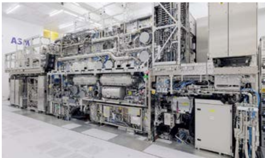
圖 1. 一台由 ASML 公司組裝完成的 EUV 光刻機，TWINSKAN EXE:5000 (3) 。
