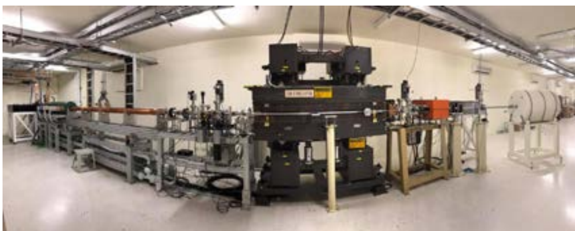
圖 5. 國家同步輻射研究中心光陰極微波電子槍系統驅動的兆赫茲超輻射自由電子雷射。
