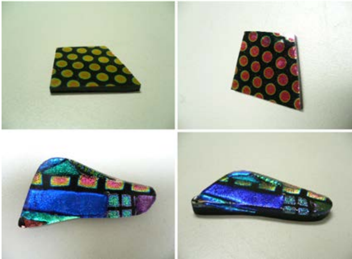
圖 7. 儀科中心鍍製的裝飾膜元件。
