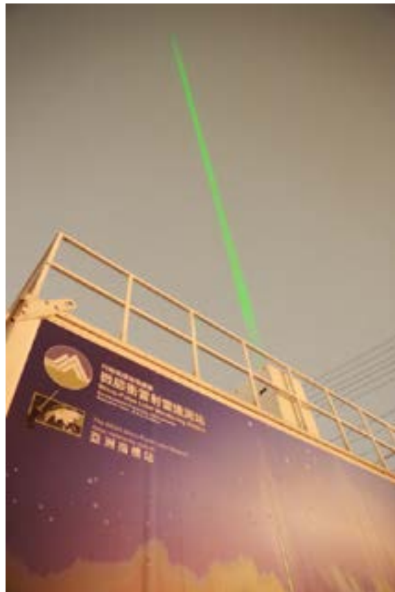
圖 4. 位於中央大學的微脈衝光達，此光達系統於 2006 年便持續觀測，提供北臺灣的空氣品質垂直分布即時資料。
