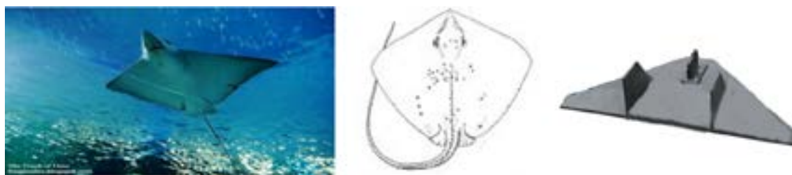
圖 5. 水下高光譜載具依魴魚仿制而成。
