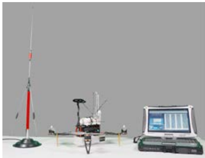
圖 3. 大氣無人機探空觀測系統設備圖。從左至右分別為通訊天線、四軸多旋翼無人機和地面站電腦(軍規筆電)。
