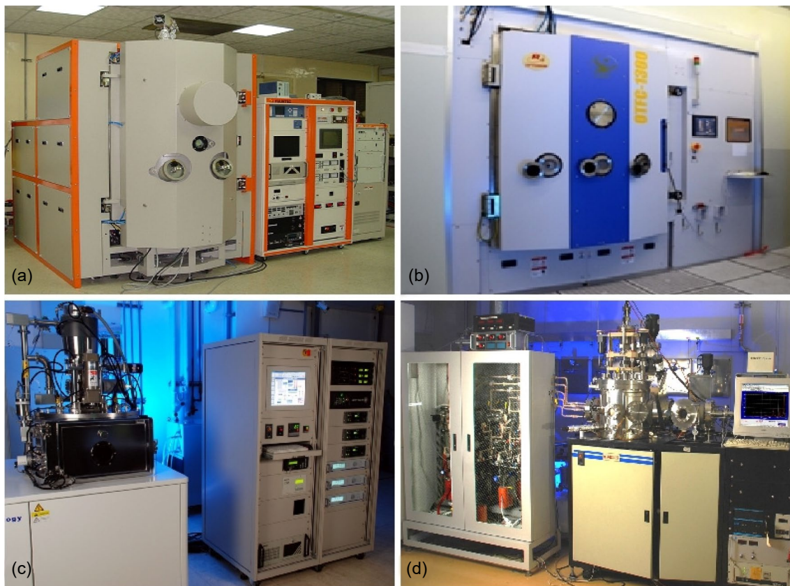
圖 4. 儀科中心的 (a) PVD 系統。(b) 蒸鍍系統。(c) 濺鍍系統。(d) CVD 系統，可提供各式光學薄膜的服務。
