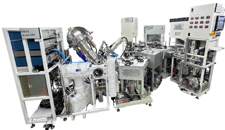
圖 1. 國儀中心自研自製六吋叢集式製程／分析平台。
