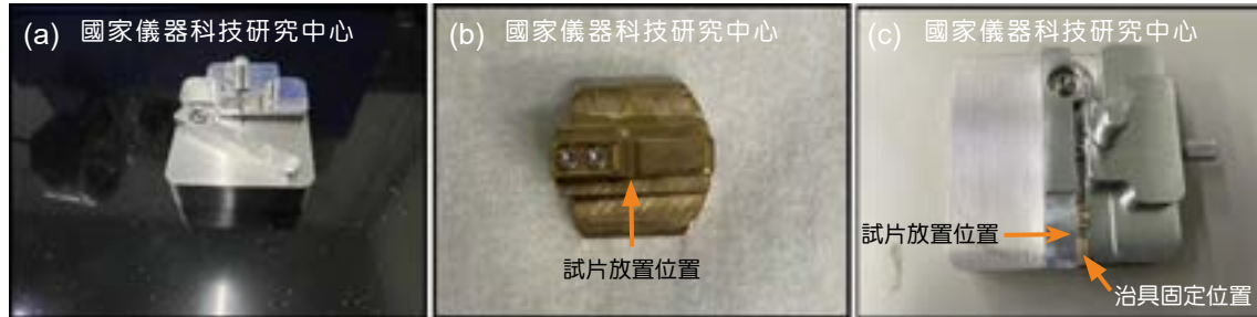
圖 9. (a) 載具一示意圖 (b) 載具二示意圖。 (c) 載具一和載具二與樣品放置示意圖。
