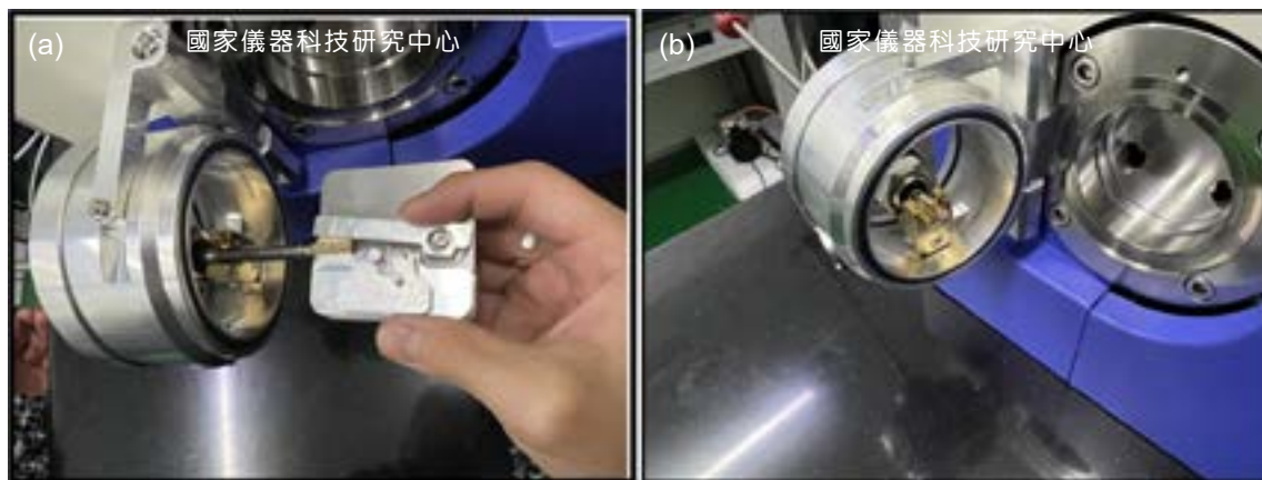
圖 10. (a) 將載具 Load Lock 之示意圖。 (b) 載具二放置進腔體前之示意圖。
