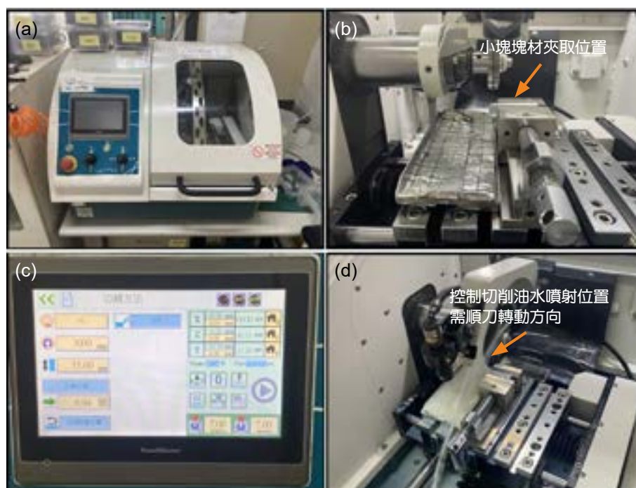
圖 3. (a) 精密切割機 (CLM50, TOP TECH)。(b) 材料處理放置與操作位置。(c) 切割機介面相關設定示意圖。(d) 機構內確認水柱噴灑位置示意圖。
