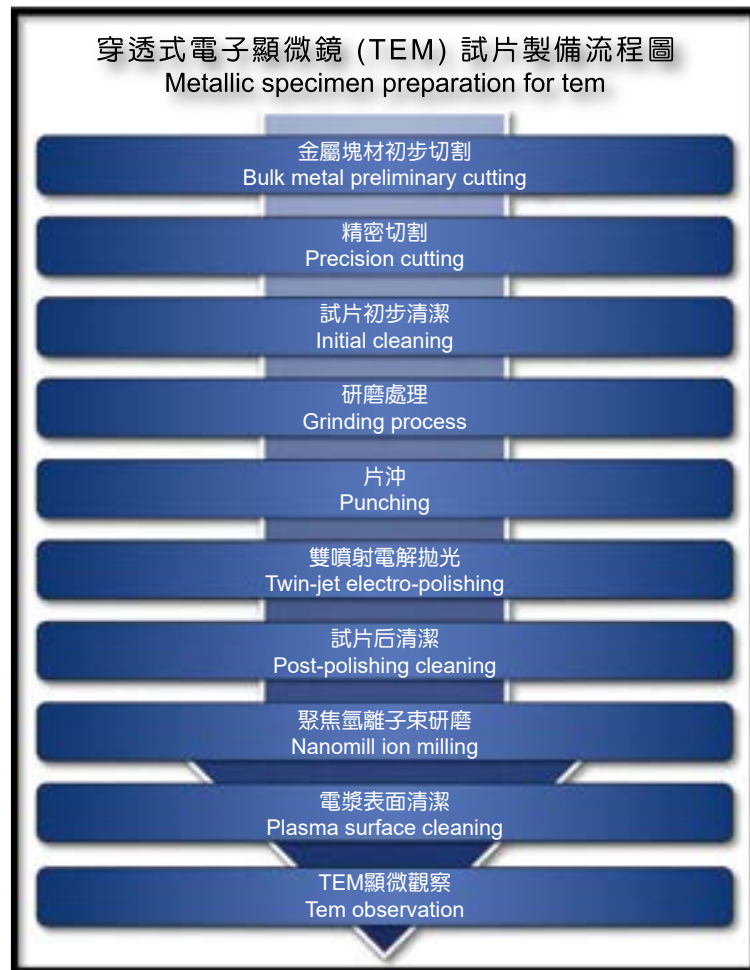
圖 1. 穿透式電子顯微鏡 (TEM) 試片製備流程圖。
