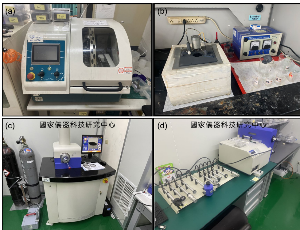
圖 2. (a) 精密切割機 (CLM50, TOP TECH)。(b) 雙面噴射電解拋光機 (Twin Jet Electro-Polishing, E.A. Fischione Instrument)。(c) 聚焦氬離子束儀器 (M1040 NanoMill, E.A. Fischione Instrument)。(d) 電漿清潔機 (Fischione Model 1020 Plasma Cleaner, E.A. Fischione Instrument)。
