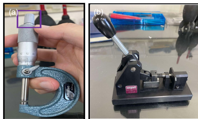
圖 5. (a) 圖為螺旋測微器，紫色方框為調整旋轉位置。(b) 圖為 Punch 壓片機。
