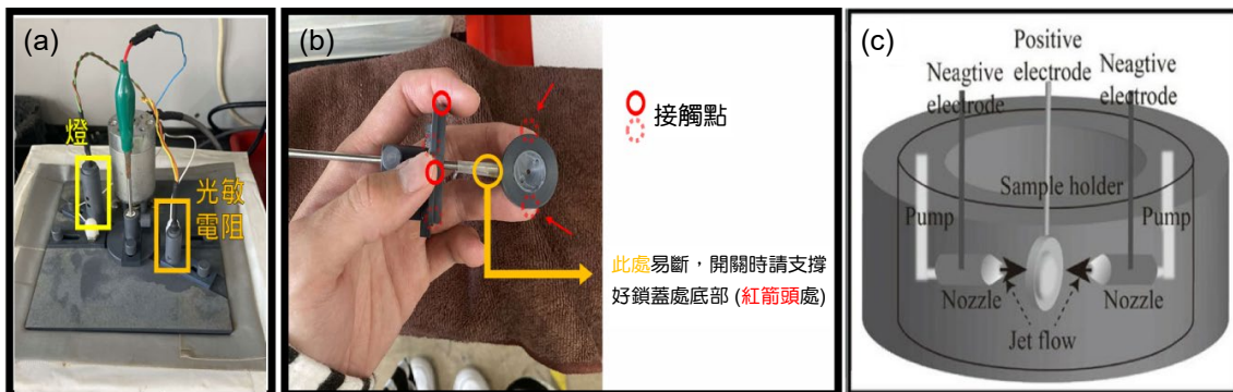
圖 7. (a) 利用電解拋光穿破試片中心產生一個洞，光源會透過去使光敏電阻產生警示聲音，用以判斷穿洞是否成功。(b) 為治具拿取方式示意圖，接觸點的正中間的小洞為試片放置處。(c) Twin jet 電解拋光之內部示意圖。
