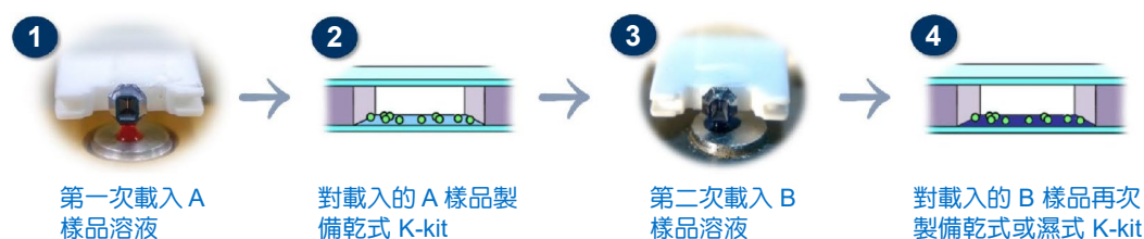
圖 12. 利用 K-kit 可執行多次樣品載入操作，且重複載入次數無限制。
