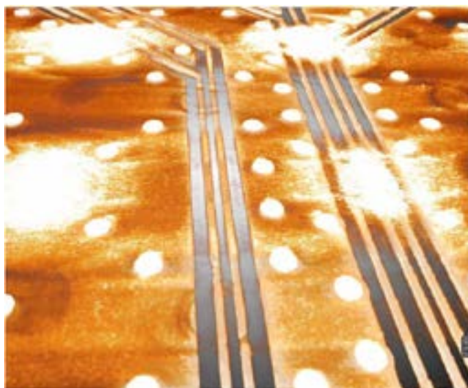
圖 7. 先進封裝佈線層透過 3D X-ray 的斷裂缺陷定位。
