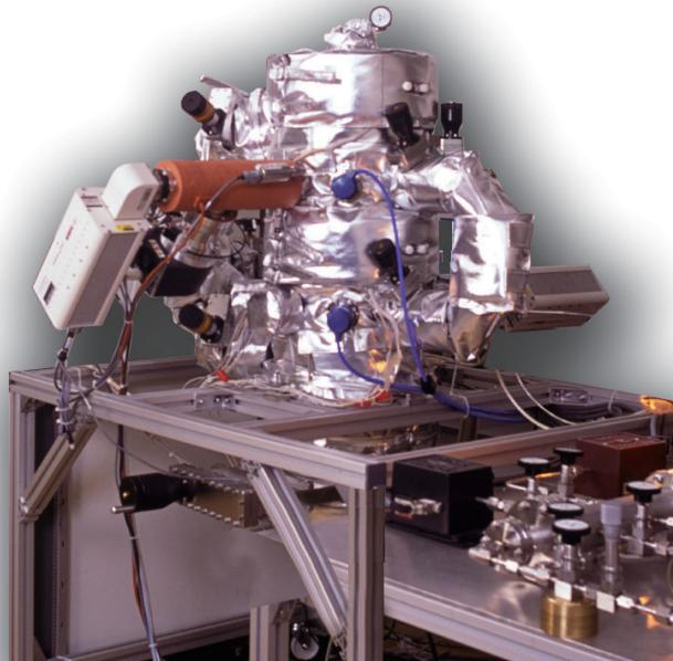
圖 4 儀科中心研製之孔口法系統，提供各界壓力基本量之校正需求。
