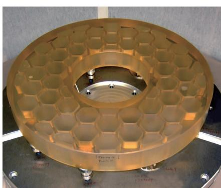
圖 10 福衛五號主反射鏡，已交付國家太空中心使用
