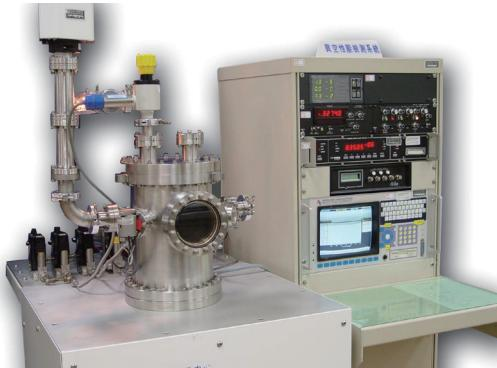
圖 3 儀科中心研製之真空幫浦性能檢測系統，目前提供國內廠商開發真空幫浦之第三方單位驗證服務
