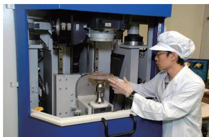
圖 9 非球面拼接式干涉檢測儀
