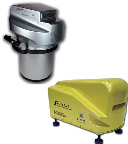
圖 2 由左至右分別為 HOPE 及 FUSHI 系統，提供國立中興大學分別使用於定翼飛機與輕航機，應用於農業、植被、水資源及地熱探勘使用
