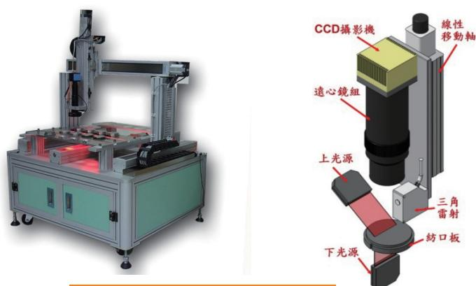
圖 5 機械視覺檢測系統與其光源模組
