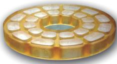
2004 年發表之口徑 300 mm Zerodur 陶瓷玻璃非球面鏡
