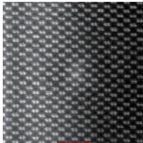
圖 11 儀科中心建置之像差修正（aberration-corrected）掃描穿透式電子顯微鏡所攝 SiGe/Si 磚晶界面之高角度環場暗視野影像（[110] 方向），顯示其啞鈴（dumbbell）狀原子結構間距為 1.36 Å，點解析度達（0.78 Å），提供國內學術界原子解析度顯微結構分析技術服務。
