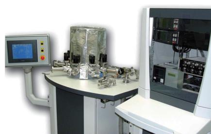
圖 10 儀科中心研製之廣域型壓力校正系統、提供國內產學研各界真空計校正技術服務
