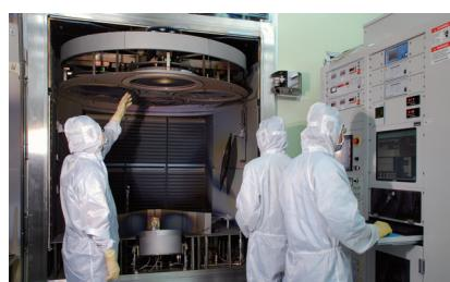
圖 5 儀科中心以離子束輔助電子槍蒸鍍系統製鍍之 Cassegrain 式太空遙測取像儀 (remote sensing instrument, RSI) 之銀反射主鏡 (直徑 1 m)，亦可提供國內太空望遠鏡主鏡重鍍之需求。
