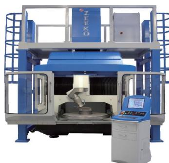
圖 8 米級非球面精密拋光與檢測系統
