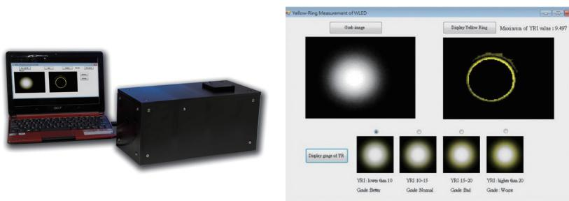
圖 8 LED 光源品質檢測裝置及其檢測結果
